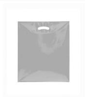
Kunststofftragetasche mit Bodenfalte aus Polyethylen mit blattverstärktem Griffloch (DKT); Format: 38x 45+ 5cm; Material: LDPE (Low Density Polyethylen/ Weich-Polyethylen) ; Folienstärke: 51µm; Farbe: transparent; Kartonmenge: 500;
